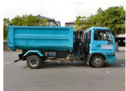
脱着装置付コンテナ専用車
